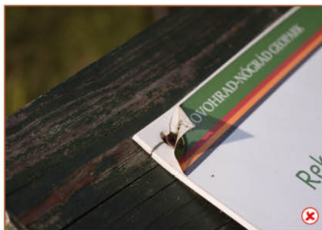
Na oboch obrázkoch je ukážka účinkov tepelnej rozťažnosti materiálov použitých ako podklad panelu. V prípade zvolenia nevhodných materiálov často dochádza k jeho poškodeniu, resp. zničeniu
