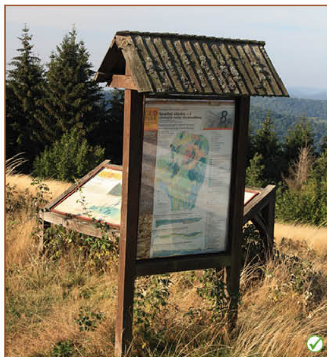
Na snímkach vpravo aj vľavo je príklad vhodne zvolenej náučno-informačnej tabule a panelu (pevná konštrukcia, ukotvenie, farba, svetlostálosť, informácie v 2 – 3 jazykoch, dobre čitateľné, s mapou).
