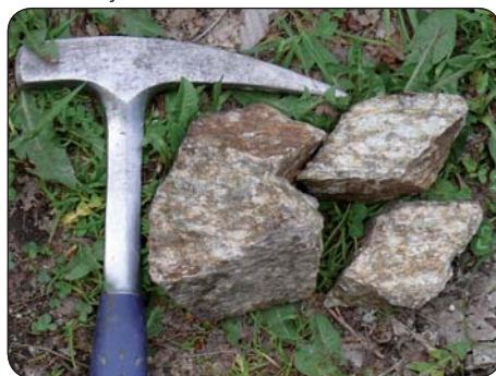
Obr. 2 Detail textúry „vyhnianskej drvenej žuly“ s výrazným usmerením svetlých výrastlíc plagioklasov, draselných živcov a kremeňa
