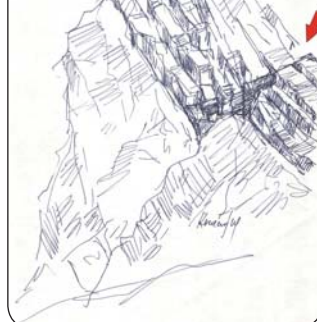
Obr. 8 Kryhový posun podľa mladšieho zlomu s priebehom 330/50° oddeľuje dva bloky. Zlom, podľa ktorého došlo k posunu blokov je indikovaný šípkou
